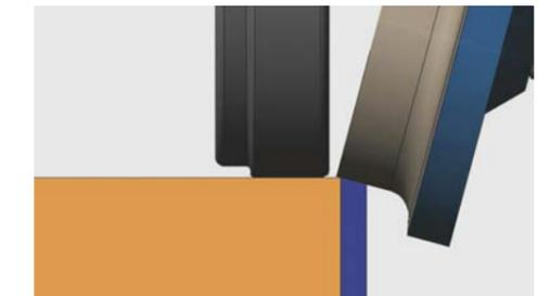
Fresado achaflanado hasta 15 grados, ajustable manualmente (opcional: ajuste neumático)
