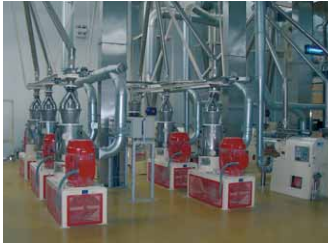
Verticone instalada en un molino de arroz en España
